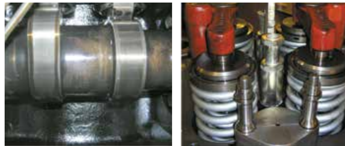
Figura 4 (izquierda). Las inspecciones del motor durante ensayos de campo revelan un árbol de levas limpio en un motor Pielstick después de 5.000 horas de operación bajo condiciones severas con Shell Argina X (izquierda). No se observaron depósitos en la cubierta de válvulas de un motor Wärtsilä 64 después de 5.000 horas de funcionamiento con Shell Argina XL (derecha).
